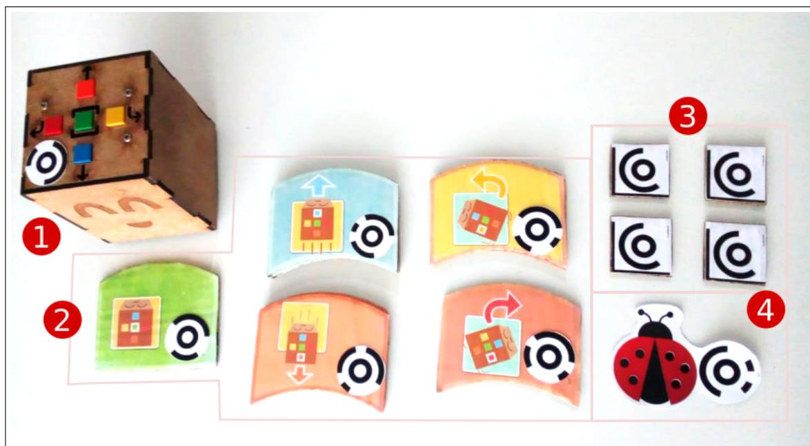
Figura 33. Elementos tangíveis. 1 - RoPE. 2 - Blocos de código. 3 - Marcadores de calibragem. 4 - Ativador de depuração.
